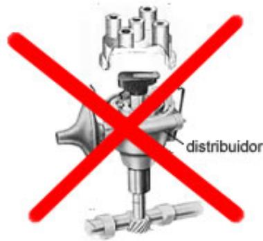
El sistema de encendido DIS (**D**irect **I**gnition **S**ystem) también llamado: sistema de encendido sin distribuidor (Distributorless Ignition System), se diferencia del [sistema de encendido tradicional](#) en suprimir el distribuidor, con esto se consigue eliminar los elementos mecánicos, siempre propensos a sufrir desgastes y averías. Además la utilización del sistema DIS tiene las siguientes ventajas:
