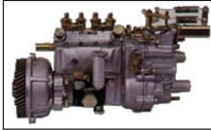
Bomba en línea tipo PE para 4 cilindros
