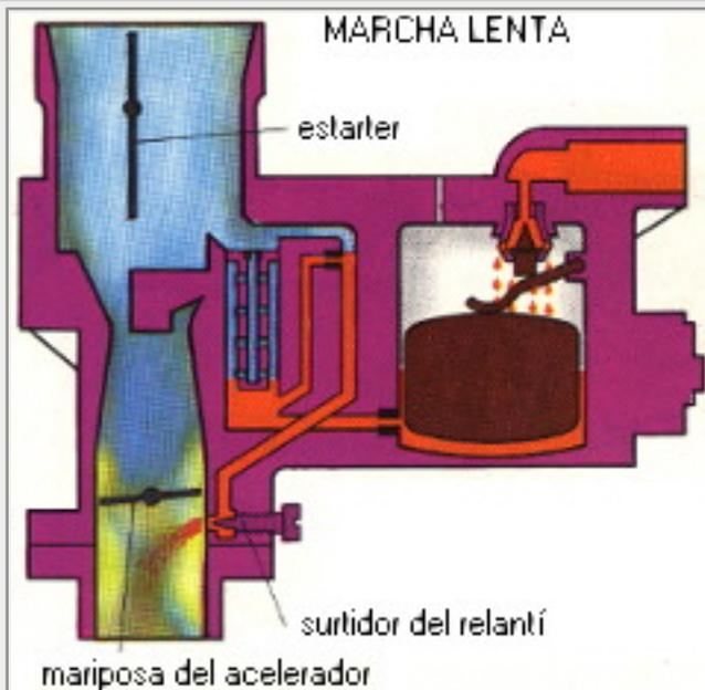
Un circuito especial, denominado de ralentí. vierte la gasolina directamente mas abajo de la mariposa, única zona en la que existe una depresión suficiente (en amarillo) para pulverizar la gasolina.
