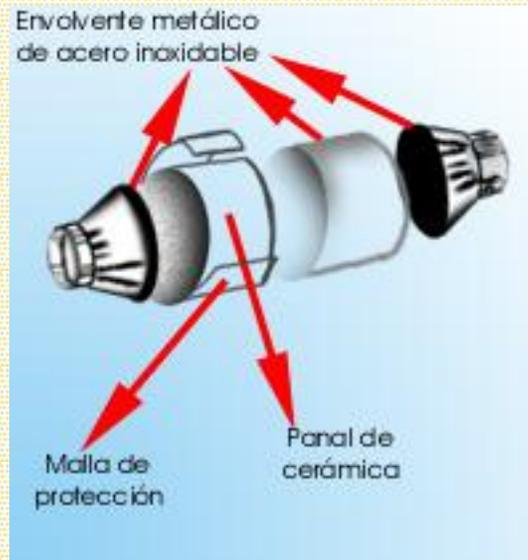
El convertidor catalítico es un dispositivo de post-tratamiento para los gases de escape con el objeto de tomar gases de poca estabilidad molecular (dañinos al cuerpo humano) para convertirlos en productos de alta estabilidad molecular y con casi nula reactividad en condiciones normales de presión y temperatura.
