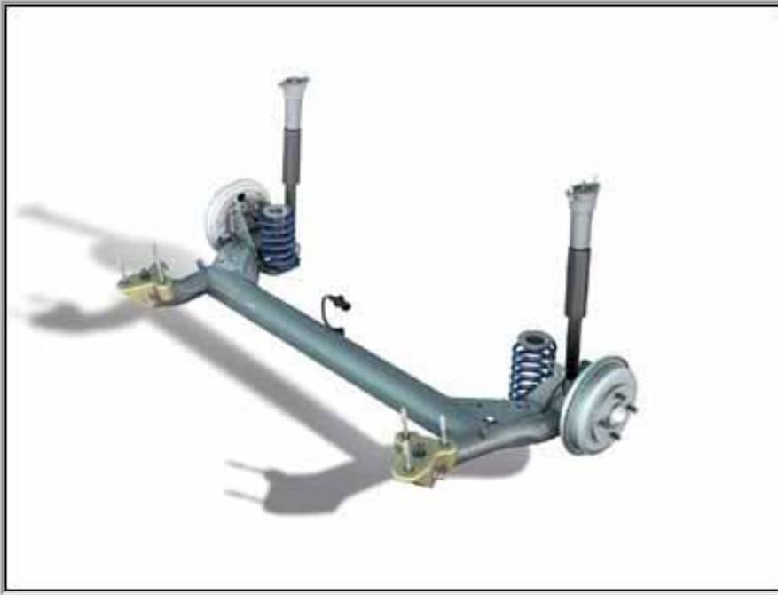
En esta radiografía podemos ver un sistema de ruedas semi-independientes o de ruedas tiradas con sus muelles y amortiguadores.
