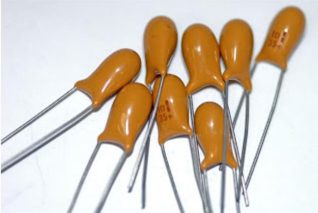
El **condensador** es un componente muy importante de muchos circuitos eléctricos. Es capaz de almacenar una determinada carga eléctrica durante un tiempo. Algunas de sus características le permiten servir para otros usos como filtrar la corriente alterna (CA) permitiendo el paso solo de corriente continua (CC).
