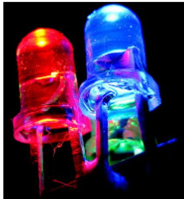
El LED (de las siglas en inglés para **Diodo Emisor de Luz**) es un diodo que emite luz cuando es traspasado por una corriente eléctrica. Como cualquier diodo solo permite el paso de la corriente en un sentido.
